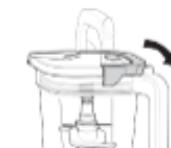
3 Na vrč namestite pokrov. Pritisnite na ročaj, dokler se ne zaskoči. Ko je pokrov zaklenjen na mestu, pritisnite gumb za vklop, da vklopite napravo. Razpoložljivi programski gumbi se bodo osvetlili in enota bo pripravljena za uporabo.
