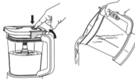
**8b** Pri gostejših mešanicah, ki jih ni mogoče izprazniti skozi izlivno odprtino, pred izlivanjem odstranite pokrov in sklop z zloženimi rezili. Pokrov odstranite tako, da pritisnete gumb RELEASE in dvignite ročaj. Če želite odstraniti sklop rezil, ga previdno primite za vrh gredi in potegnite naravnost navzgor. Nato lahko vrč izpraznите.
