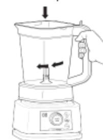
2 Spustite vrč na podstavek motorja. Ročaj mora biti poravnан rahlo v desno, vrč pa mora biti usmerjen tako, da sta na podstavku motorja vidna simbola LOCK. Vrteči vrč v smeri urinega kazalca, dokler se ne zaskoči na mestu.
