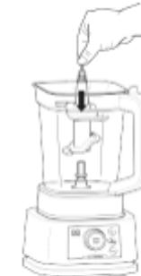
**3** Previdno primite sklop rezil za testo za zgornji del gredi in ga namestite na pogonski mehanizem v vrču. Upoštevajte, da je sklop rezil se ohlapno prilega pogonskemu zobniku.
