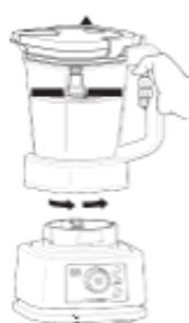
**7** Odstranite vrč s podstavka motorja tako, da ga zavrtite v nasprotni smeri urinega kazalca in ga dvignite.
