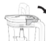
**5** Na vrč namestite pokrov. Pritisnite na ročaj, dokler se ne zaskoči. Ko je pokrov zaklenjen na mestu, pritisnite gumb za vklop, da vklopite napravo. Razpoložljivi programski gumbi se bodo osvetlili in enota bo pripravljena za uporabo.
