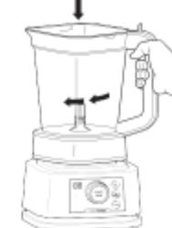
**2** Spustite vrč na podstavek motorja. Ročaj mora biti poravnан righth в desno, vrč pa mora biti usmerjen tako, da so na podstavku motorja vidni simboli LOCK. Vrtevi vrč v smeri urinega kazalca, dokler se ne zaskoči na mestu.
